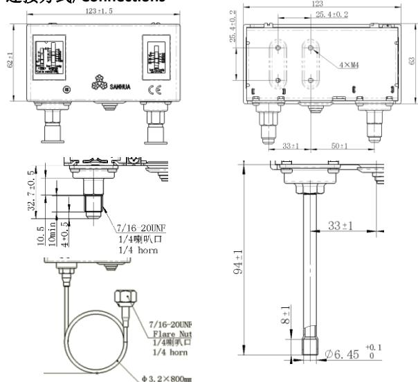
接头连接方式可根据客户要求提供，接头配备防尘帽，防止异物进入感压部件，导致进气口堵塞，影响产品动作性能。
