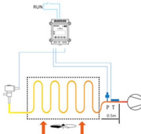
Recomendamos instalar los sensores de temperatura y presión a menos de 0,5 m del evaporador para evitar la interferencia de la temperatura ambiente y la caída de presión para el cálculo del recalentamiento.
