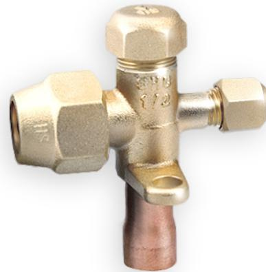
Die Serviceventile der SSV Serie werden häufig zum Verbinden von Innen- und Außengeräten bei Split-Klimaanlagen eingesetzt. Darüber hinaus ist die SSV-Serie auch in anderen Kältesystemen vielfältig einsetzbar. Durch Betätigung des Ventilschafts kann der innere Strömungsweg der Ventile geschlossen werden. Die 3-Wege-Ausführung (mit Füllanschluss) kann als Serviceventil für den Anschluss von Vakuumpumpen oder zur Befüllung mit Kältemittel verwendet werden.
